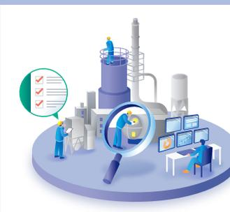
数か月かけてプラントの試運転を行い、機器やシステム全体が正常に作動するかを確認します。試運転期間の後半には実際に廃棄物や燃料を投入して燃焼させ、プラント全体の性能に問題がないかを確認します。
