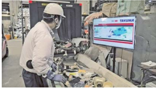
図5 LiB 除去作業の様子
