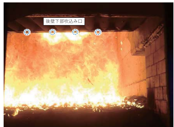
図4 二次燃焼空気後壁下部吹込み口での燃焼状況（パターン②）
