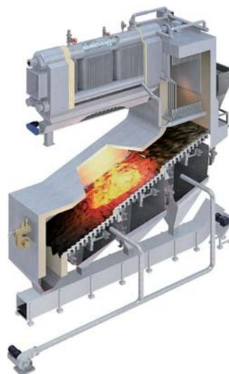
図3 階段式ストーカ炉の概略図
