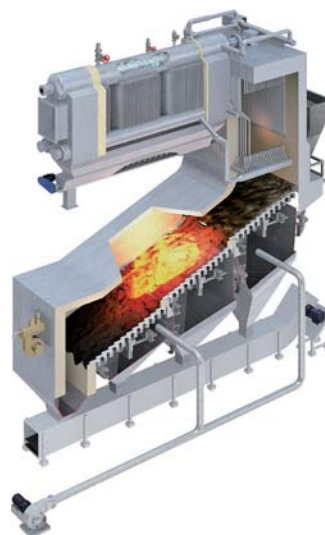
図3 階段式ストーカ炉の概略図
